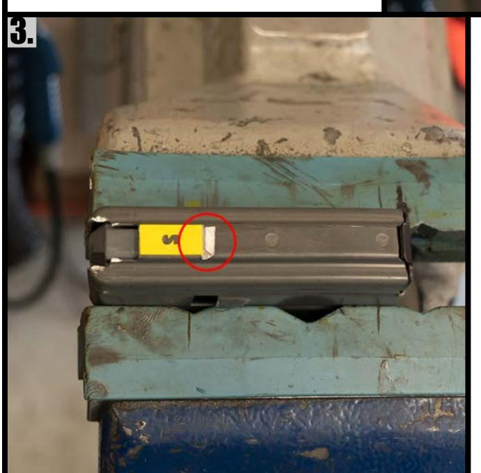
(3) FINISHED MAGAZINE SHOWING NOTCH. REMOVE DECAL BEFORE TESING MAGAZINE
